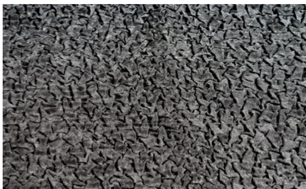
RADISHIELD 捲縮シートはフラットシートに特殊な加工を施すことで、伸縮性、柔軟性共に向上させ、かつ散乱線の遮蔽に有効である。ガンマ線遮蔽率が同様の場合、捲縮シートはフラットシートに比べ、30%ほど軽量。捲縮シートが持つ凹凸構造は周辺からくる多方向の環境放射線を遮り、軽くて高い実行遮蔽を実現。
